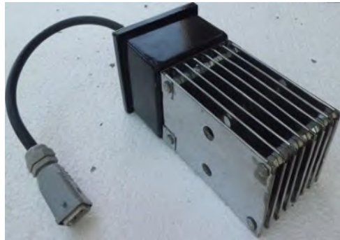
Şekil 15.3. Çoklu düz levha tipi ısı değiştirici
