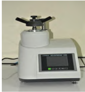
Şekil 3.1. Kalıplama için kullanılan bakalite alma cihazı
