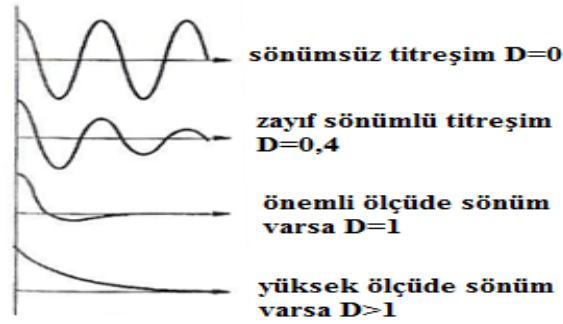
Şekil 7.4. Sistemdeki sönüm derecesine göre elde edilen grafikler [2]
