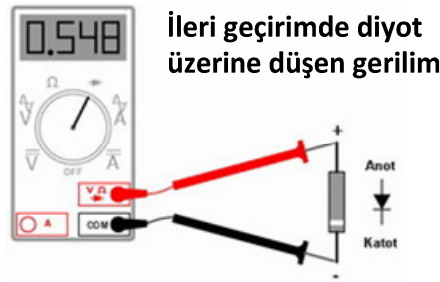
Şekil 1.6 Multimetre test kademesi kullanılarak diyotun test edilmesi
